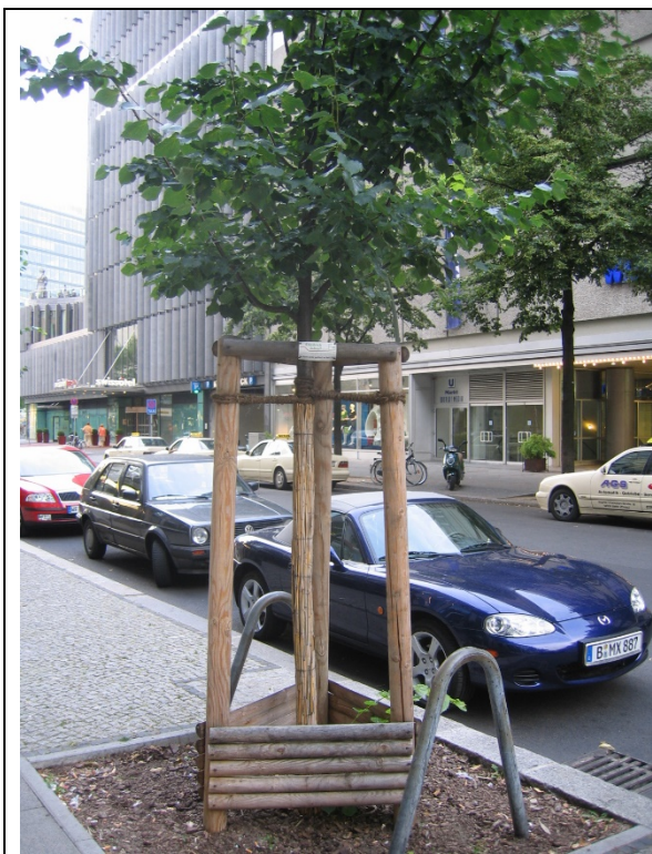
Il. 1. Przykładowe rozwiązanie stabilizacji drzewa po posadzeniu. Pionowe paliki spięte rzędami poziomych stężeń
